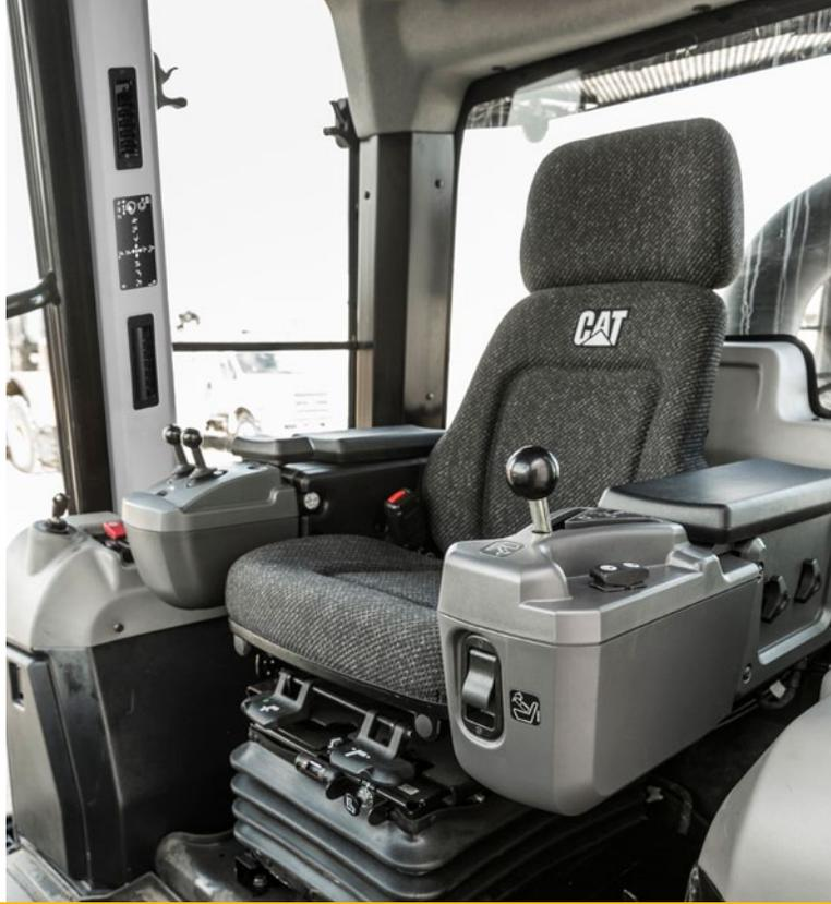
La cabine améliorée offre un meilleur confort au conducteur grâce à l'ajout d'accoudoirs et de commandes réglables, d'un système de climatisation amélioré et d'un siège chauffant et ventilé en option. Avec le nouvel écran LCD, il est facile de personnaliser les caractéristiques de rendement de la machine et de visualiser le fonctionnement de la machine et les informations sur l'entretien.
