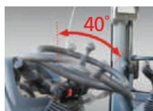
Colonne de direction inclinable / télescopique
